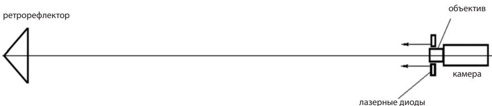
Рис. 8. Излучатели расположены вокруг оптической оси объектива
