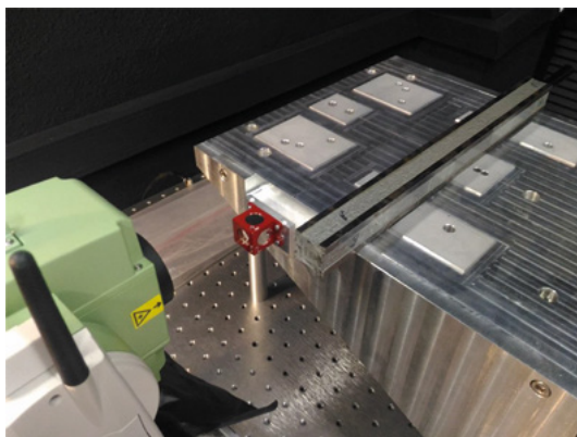
Рис. 4. Определение линии классный паз – классное отверстие при помощи лекальной линейки
