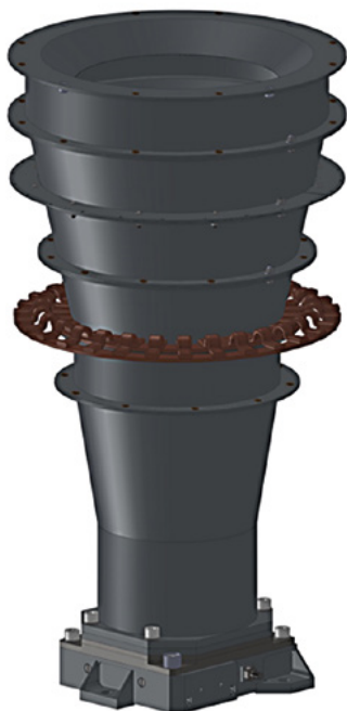
Рис. 16. Оптическая головка с тепловой развязкой бленды, выполненной с помощью углепластикового кольца и вводом гибкого теплопровода
