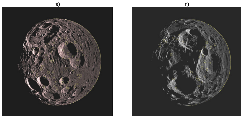
Рис.1. Модельные изображения Луны, получаемые СШНК с полем зрения 180^\circ с высоты 100 км на меридиане 45^\circ в.д. и широтах 0 (а), и 25^\circ (б), 50 (в) и 70^\circ ю.ш. (г) детектированные дуги горизонта и контрольные точки показаны жёлтым цветом
