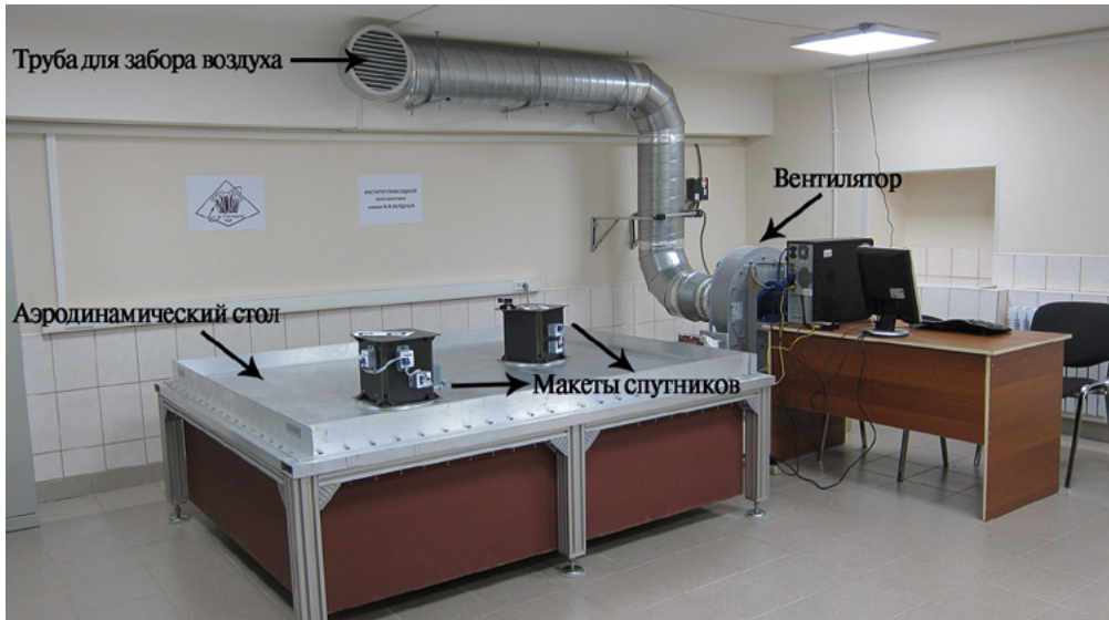
Рис. 4. Стенд КОСМОС для моделирования относительного движения макетов систем управления микроспутников
