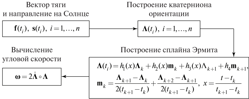
Рис. 1. Построение углового движения КА
