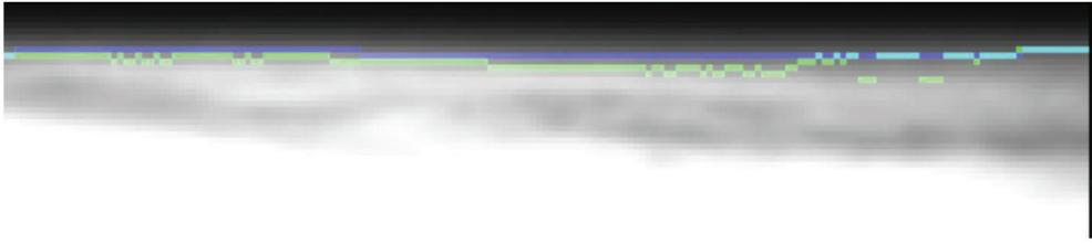
Рис. 2. Фрагмент снимка с ИСЗ GOES-East, показывающий неоднородную облачность на лимбе: зелёный цвет — условный горизонт, определённый по критерию MAXGRAD, синий — по критерию MAX/2, циан соответствует случаю, когда оба критерия совпадают
