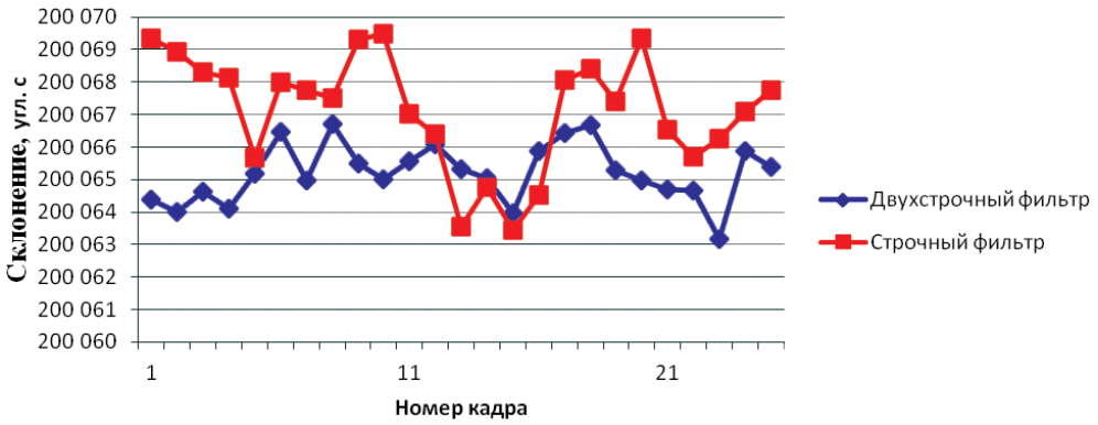
Рис. 18. Разброс параметра «Склонение между кадрами в статике»: строчный фильтр, СКО_{\delta} = 1,76 угл. с; двухстрочный фильтр, СКО_{\delta} = 0,90 угл. с
