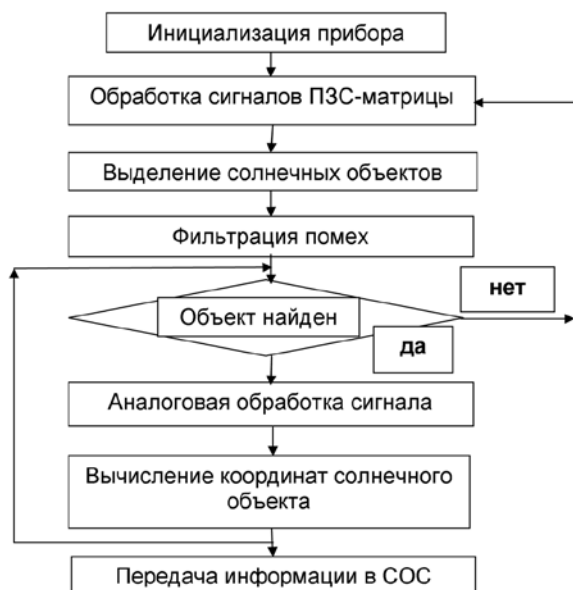
Рис. 2. Алгоритм работы датчика (СОС — система ориентации и стабилизации космического аппарата)
