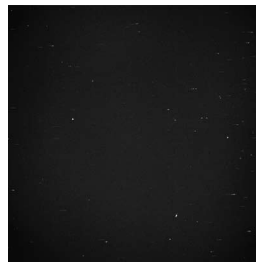
Рис. 4. Изображение, полученное с ПЗС-матрицы KODAK KAI-1020M при падении протонов под углом к поверхности
