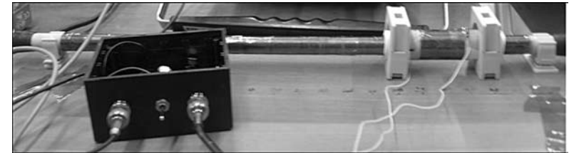
Рис. 9. Лабораторная установка для оценки эффективности работы гистерезисных стержней
