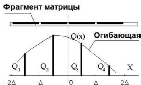
Рис. 4. Форма полезного сигнала, формируемого отверстием диафрагмы (по одной координате): Q_1...Q_4 — отсчеты сигнала в чувствительных элементах 1...4; \Delta — шаг матрицы (размер элемента разрешения)
