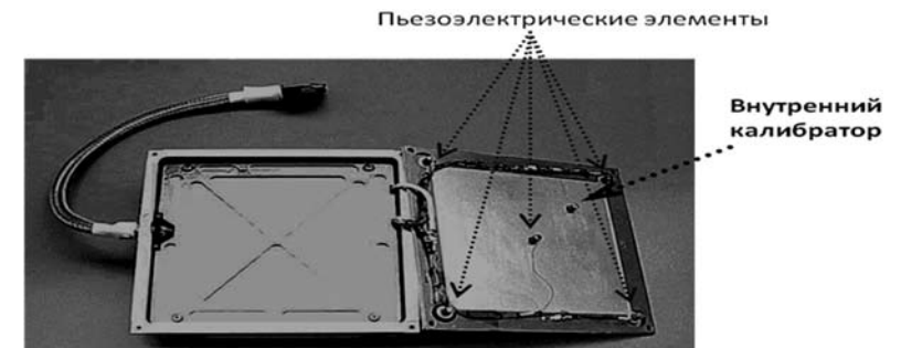
Рис. 3. Строение ударного сенсора IS прибора DIAMOND
