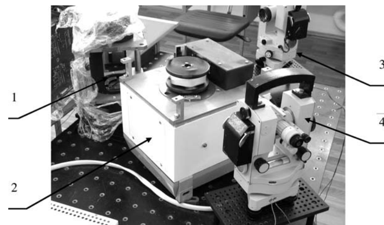
Рис. 1. Измерение СИУПСЗ параметров закона сканирования однокоординатного прецизионного сканирующего устройства ПКР-Т: 1 — сканирующее зеркало устройства ПКР-Т; 2 — динамический гониометр; 3, 4 — теодолиты
