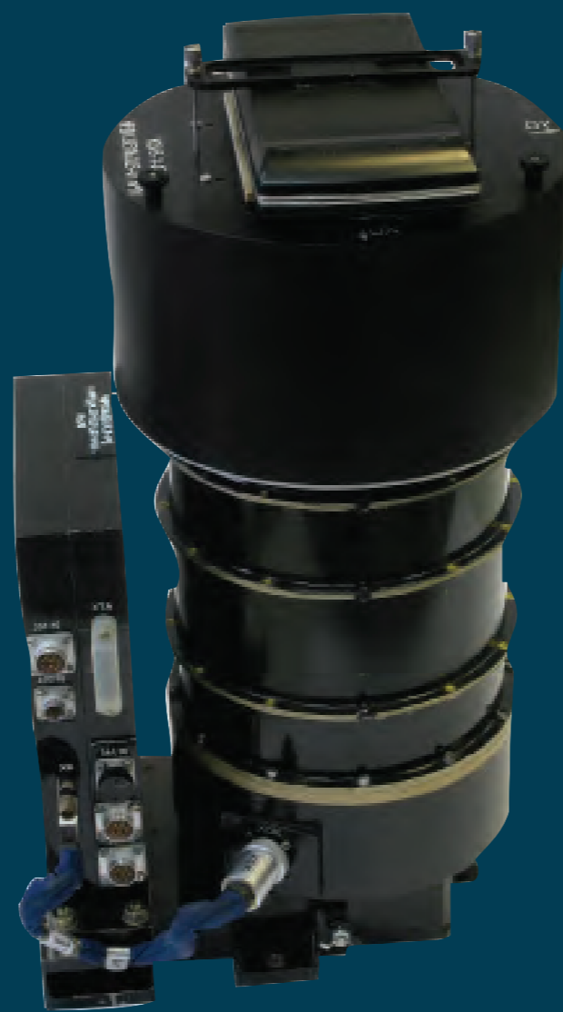
Внешний вид прибора БОКЗ-М с установленным КБИЗ
