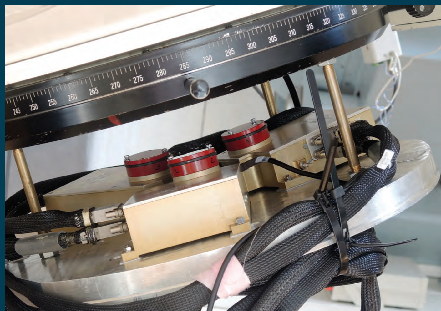
Испытания СДГ в САО РАН Датчики гида на телескопе Цейсс-1000 (САО РАН, 2014 г.)
