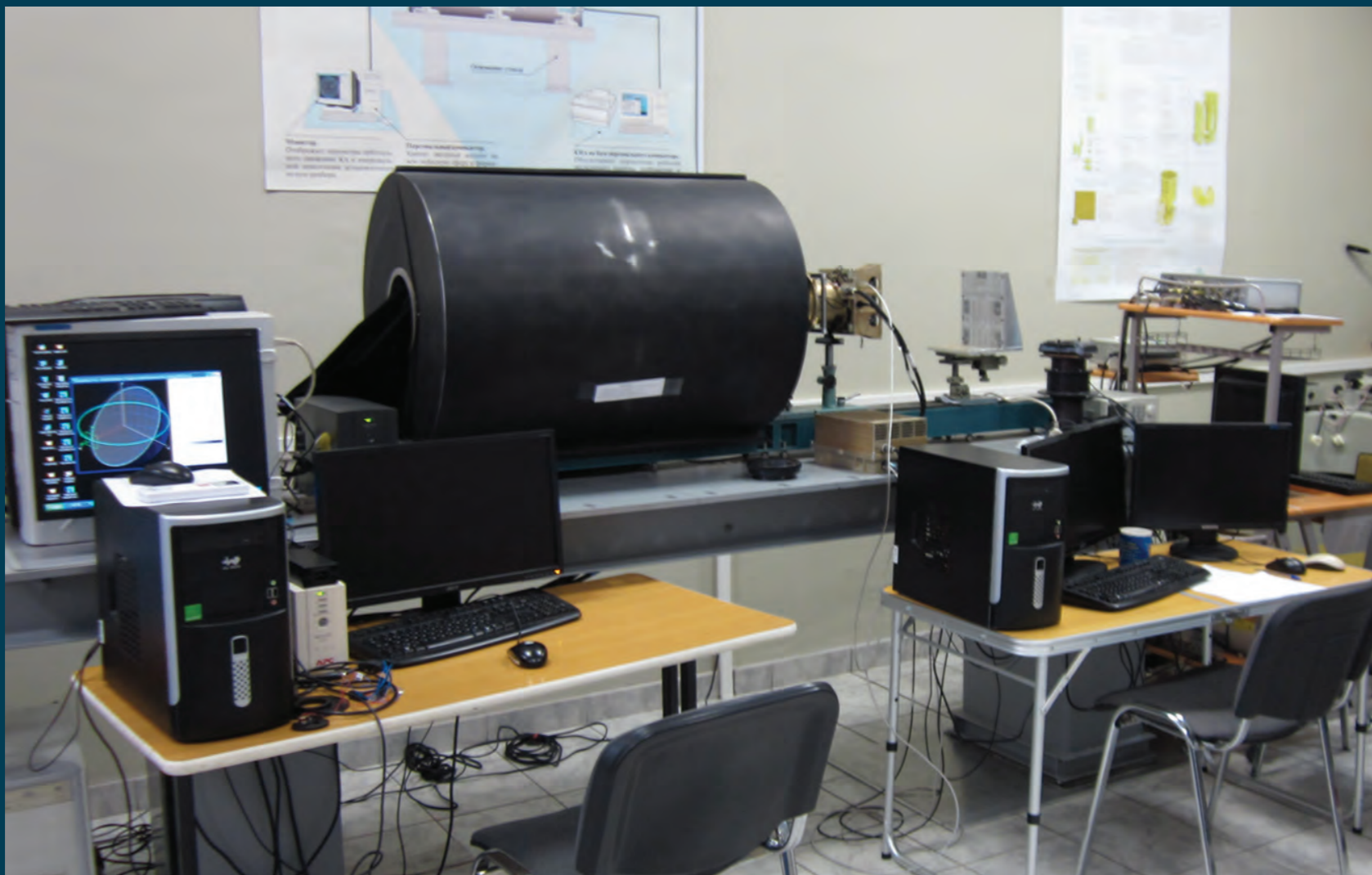
Стенд динамических испытаний звездных датчиков
