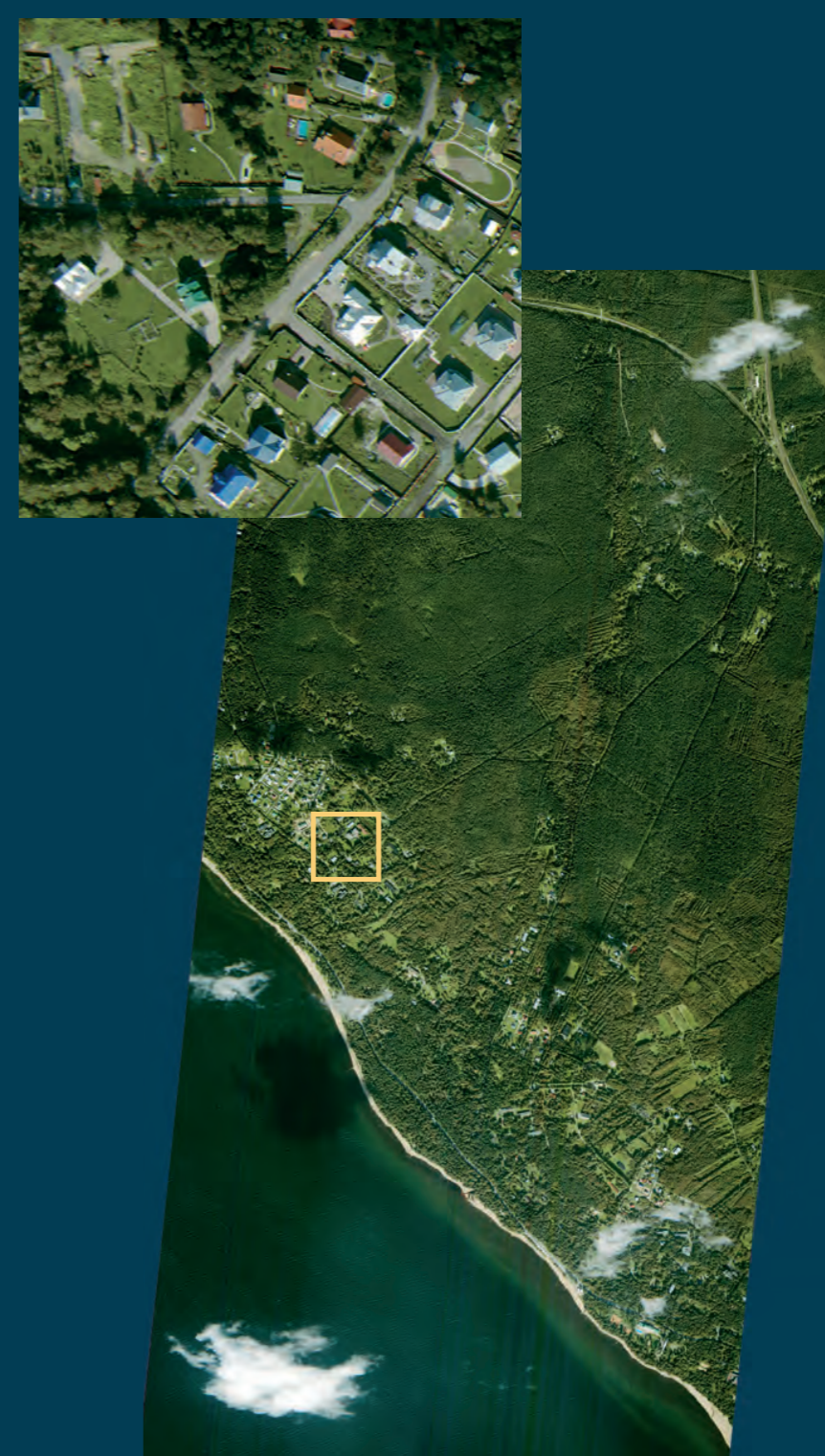
Фрагмент полосы, снятой цифровой аэрокамерой ЦМК-70 с высоты 4000 м
